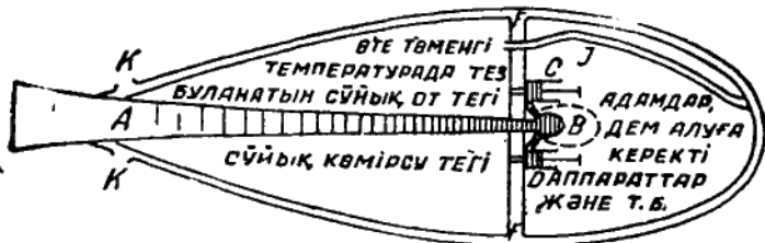
Циолковскийдің ракета кемесі құрылысының схемасы.
