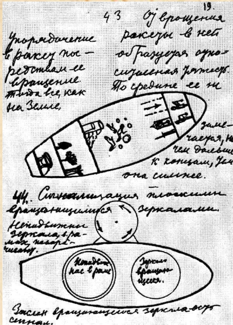
Создание на борту орбитальной станции искусственной тяжести путем ее вращения («Альбом космических путешествий»)
